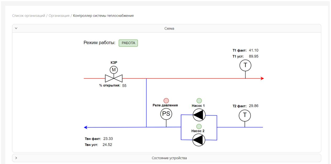
При раскрытии вкладки «Состояние устройства» отобразится таблица с данными поступающими с устройства. Опрос устройства осуществляется 1 раз в минуту 24x7.
